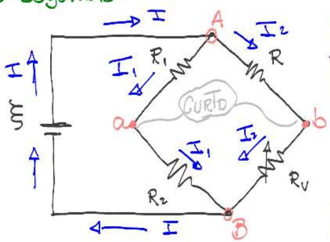
■ Não sabemos o valor de  $R$ , mas podemos controlar o valor de  $R_v$  até que  $I_{ab} = 0$ , ou seja, os pontos A e B estão sob o mesmo potencial  $\Rightarrow V_{ab} = 0$ . Assim fica fácil verificar que as quedas de potencial entre os pontos  $V_{AA} = V_{AB}$  são iguais, assim como  $V_{AB} = V_{BB}$ , temos:
