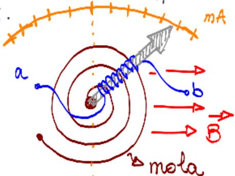
a) SE pelas terminais a e b passa uma CORRENTE CONTÍNUA  $I = \text{cte}$ , um torque  $\vec{\tau} = \vec{\mu} \times \vec{B}$  faz com que o ponteiro se desloque da posição de equilíbrio central. ( $\vec{\mu} = IA^*$ )
