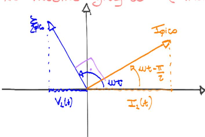
\* Podemos então dizer que a corrente no "círculo" está atrasada com uma diferença de fase de 90° ( $\frac{\pi}{2}$ ) c/ relação à tensão no Indutor (ou vice-versa)
