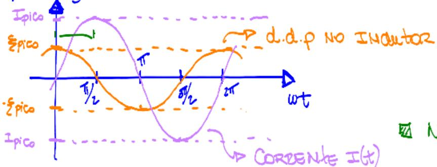
\* A CORRENTE ESTÁ ATASADA  $\pi/2$  ( $90^\circ$ ) C/ RELAÇÃO À QUEDA DE POTENCIAL DO INDUCTOR
