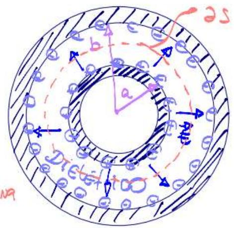
A capacitância do sistema é dada pela razão entre a carga  $q$  e a diferença de potencial entre as camadas (a,b),  $\Phi_{ba}$ . O campo elétrico pode ser calculado pela lei de Gauss, devido a alta simetria do sistema. E desprezando efeitos de borda (anisotropia do campo elétrico), temos:
