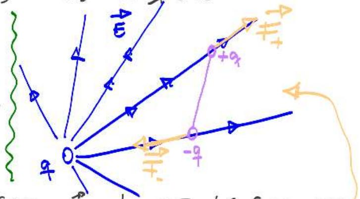
Lembre-se que p/ o campo uniforme  $\vec{E} = \text{cte}$  não há força resultante atuando sobre o dipolo. O mesmo não é verdade para um dipolo num meio com campo radial por exemplo. Mesmo no caso uniforme o torque nos dipolos pode causar uma dissipação de energia no dielétrico na forma de calor.
